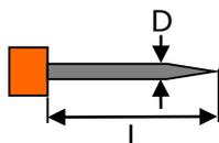
**注意：电极棒为消耗品，必须使用住友原装产品。否则可能会引起熔接机故障以及性能低下和高熔接损耗等现象发生。**
