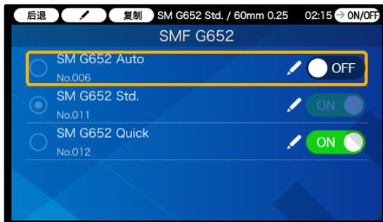
3: 登录已解除。可以用设置键(→)进行 ON/OFF 的切换。
