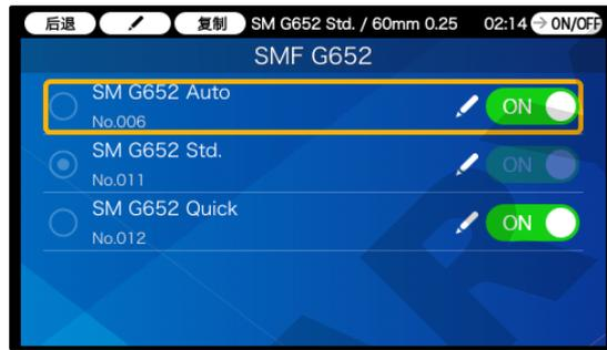
2: 在熔接条件中，用光标指向希望登录和解除的条件，按下设置键(→)。
