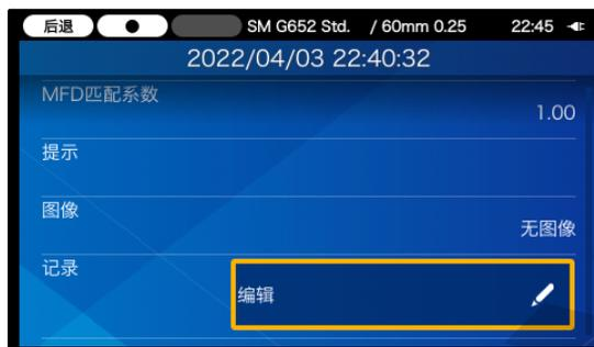
在熔接数据确认画面中，光标指向提示图标选定。(F2键)，在提示中可以输入。
