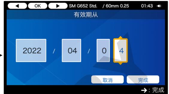
4: 指定密码要求的启动日期。利用(▼▲)切换来变更数值。光标□通过**F1**键和**F3**键左右移动。
