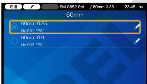
3) 用光标指向希望的加热条件，选定编辑图标
