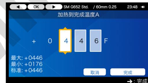
5) 利用（**▼▲**）键可以变更数值。光标
