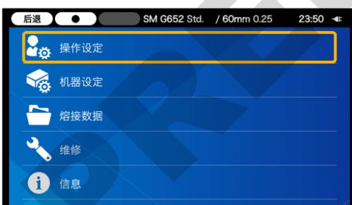
3) 选定操作设定图标。( **F2** 键) 可以在操作设定画面上移动。
