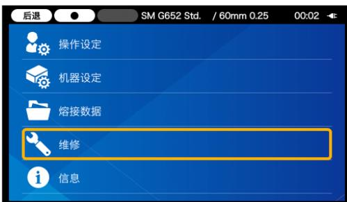
2) 在菜单画面中，选定维修图标，并确定 (**F2** 键)。在维修画面中移动。
