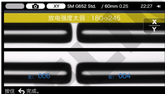
7: 通过图像处理测定左右光纤的熔化量和放电中心位置，并在显示器上表示出来。(放电中心位置只会在位置更新时才表示出来)。
