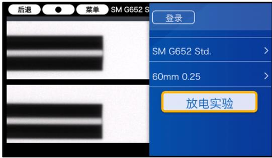
4: 用 键、 键控制光标 ，指向 Arc Test 选定。(F2 键)
