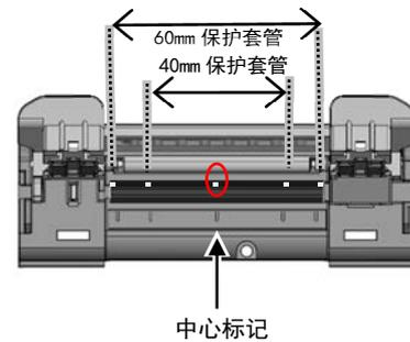
保护套管按照中心、40mm、60mm 的刻度放置好光纤。
