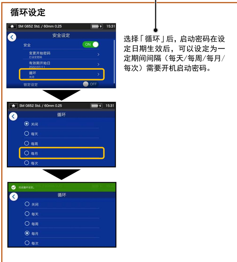
请注意如果忘记启动密码，机器无法启动。万一忘记启动密码，请与本公司维修中心联系。
