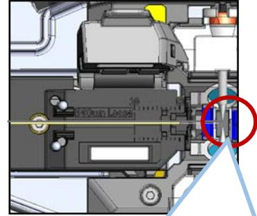
2) 将光纤前端放置在 V 型槽和电极棒之间。
