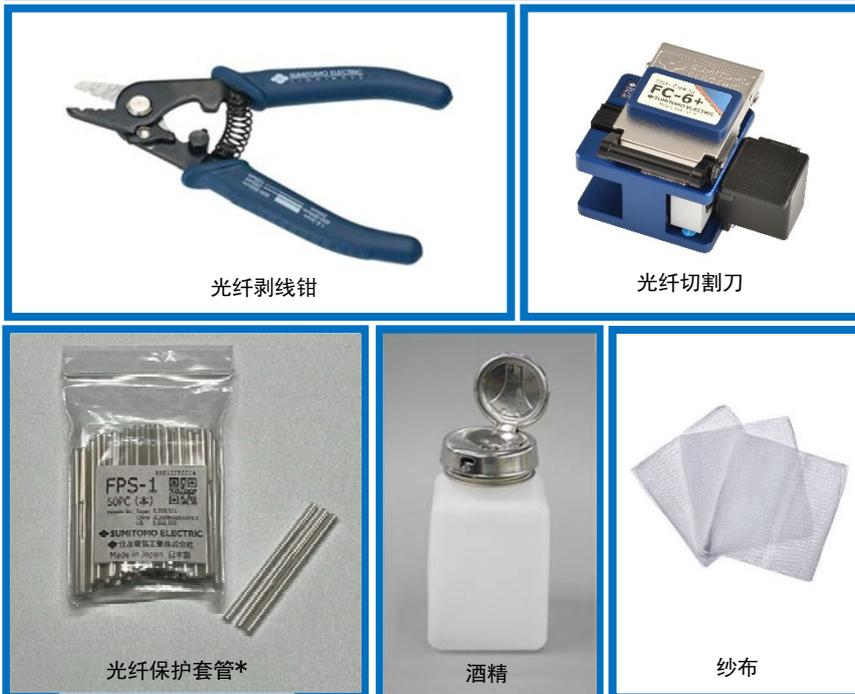
\*切断长度不同，使用的保护套管也不同。请注意。▶ P. 5-2
