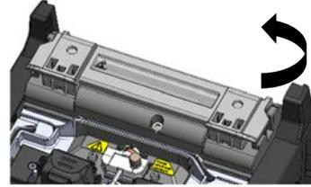
2) 打开防风盖和光纤夹具。将熔接完成的光纤取出，请注意不可弯曲或拧转光纤。将事先穿入的保护套管（▶P. 2-17💡）左右均匀的移至熔接保护点。
