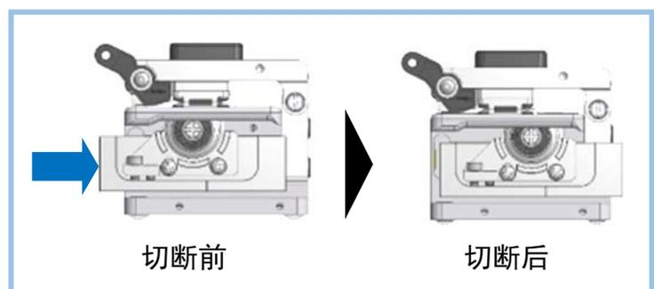
5) 打开夹具开闭杆，打开单芯夹具盖。取出切断的光纤。再将光纤碎渣从切割刀中取出，放入特定收容盒中
