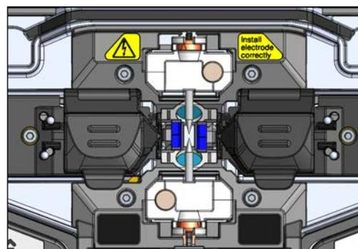
安装电极棒的位置不合适,可能造成熔接状态不稳定,或器材损坏。
