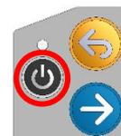
将 AC 交流适配器的输出线插入 DC 输入端子后马上按下电源开关时，需要数秒才能通电，这种情况不属于故障。
